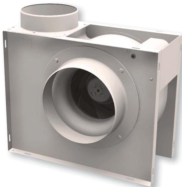
Центробежные вентиляторы одностороннего всасывания серии СКВ-N комплектуются рабочими колесами с загнутыми вперед лопатками. Вентиляторы изготовлены из листовой стали и защищены от коррозии эпоксидно-полиэфирной краской бежевого цвета. Рабочие колеса изготавливаются из пластика (модель 800N) или из оцинкованной листовой стали (модель 1500N). Вентиляторы оснащаются патрубками со стороны входа и выхода воздуха. Патрубок со стороны выхода воздуха оборудован обратным клапаном.
